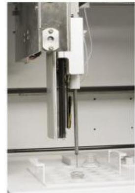
Sonda de reactivo/muestreo con detección de nivel de líquido
