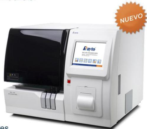
RAC 050 cuenta con un área de muestras de 27 posiciones para tubo primario o copa, el área de reactivos con una bandeja refrigerada de 23 posiciones, área de reacción con capacidad de 72 cubetas a bordo y el área del pipeteador con precalentamiento, protección anti-choque, detección de nivel de líquido y chequeo de inventario.
